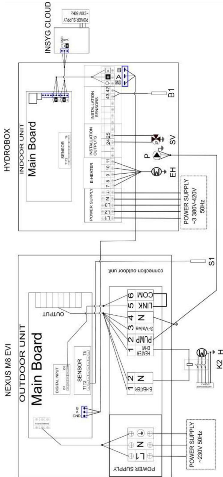
**Bezeichnungen:** EH- Durchlaufheizstab (empfohlener Anschluss an die Inneneinheit INSYG ALFA), K2- Schütz für BW-Speicherheizstab, H- BW-Heizstab, SV- PUFFER / BW Umschaltventil, S1- Brauchwasser-Sensor, B1- Puffer-Sensor. **Outdoor unit (main board)** - Hauptplatine der Wärmepumpe (Außeneinheit mit 1 Phase), **Hydrobox (main board)** - Hauptplatine der Steuereinheit (Inneneinheit), **Insyg Cloud** - das WIFI-Modul des Internetsystems. **Power Supply**- Stromversorgung.
